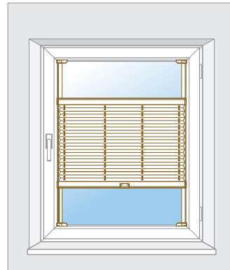
Montage auf die Glasscheibe mit Klebeprofil.
