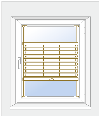
Montage in die Glasleiste mit Spanschuh (verschraubt).
